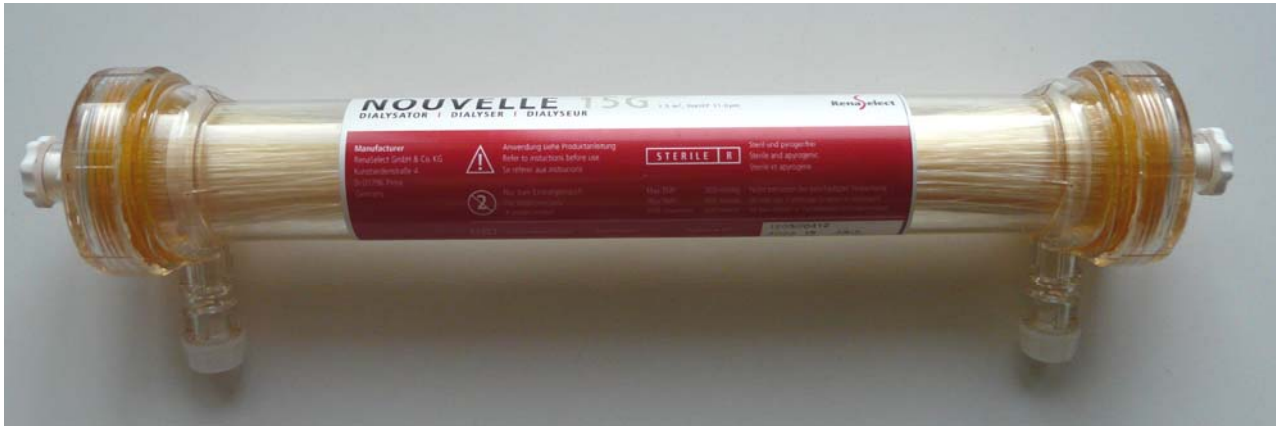
Filterelement aus funktionalisierten Zellulose-Hohlfasern für die Dialyse, entwickelt durch die FSU Jena. Foto: Markus Jahreis
